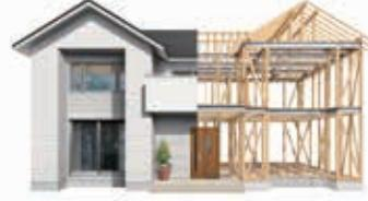
パナソニック独自の「テクノストラクチャー工法」で建てる木造住宅。それが「テクノストラクチャーの家」。木の温もりに鉄の強さをプラスした地震に強い家です。構造計算で耐震性や耐久性も確認し確かな安全性を実現します。
