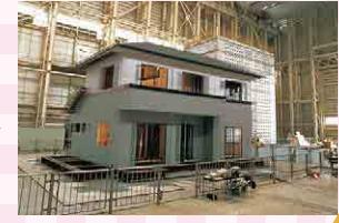
実物大のモデルによる振動実験を行い、震度7の激震を計5回与えても構造強度に影響のない強さが実証されています。また注文1棟ごとに構造計算を実施。388項目にも渡る構造計算が発行され、建物の強さを保証します。
