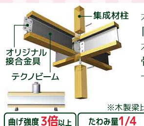
木の弱点を鉄の強さで補強したオリジナル部材「テクノビーム」を使用。新築から30年後の通常の木の梁と比べると「たわみ」が1/4以下と少なく、骨組み全体のゆがみが抑えられます。地震などの一時的な大きな力に強いのも安心ポイントです。
